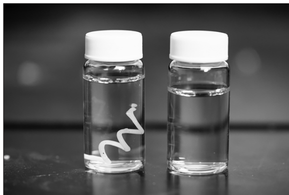
最初装塑料的罐子 → 数天后的罐子
